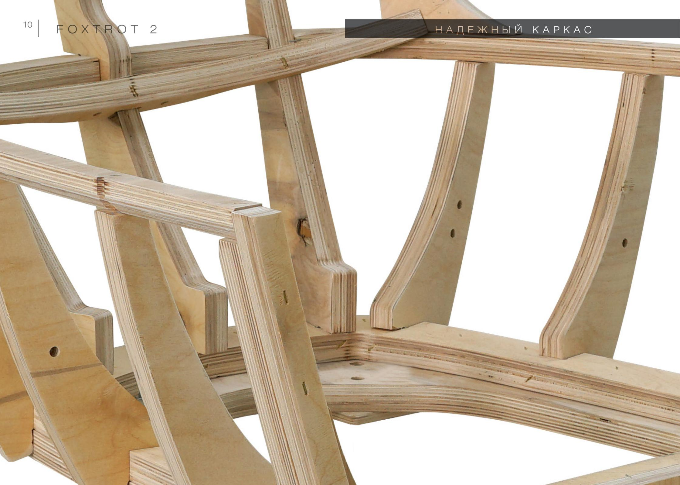
Легкость и прочность конструкции креслу обеспечивает его тщательно проработанный каркас. Он выполнен полностью из березовой конструкционной фанеры толщиной 24 мм, которая характеризуется высокой надежностью. Соединения деталей в каркасе продублированы. Сначала детали соединяются на клей, после чего фиксируются на винт или мебельную скобу.
